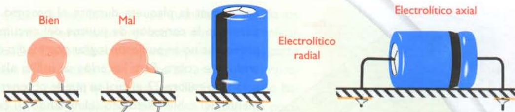
Figura 6.10. Montaje de los condensadores
